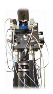
Die benötigte Energie für die schnelle Öffnung/schnelle Schließung wird durch die Öffnung des Cartridge-Ventils (LBA30AA700) aus der Speicherbatterie bereitgestellt.
