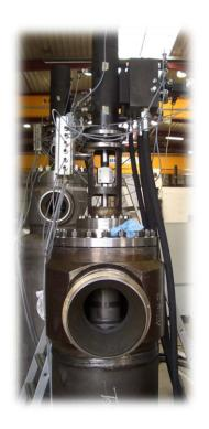
Eine Pumpe ist in Betrieb, die auf Grund der eigenständigen Öl-Stromregulierung den maximalen Öl-Strom sowohl für das Aufladen der Öldruckspeicher, als auch für die normale Positionierung der Ventilkegel über die Proportionalventile, sicherstellt.
