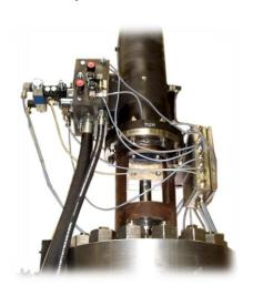
Das Hydraulikaggregat versorgt die Hydraulikzylinder auf den HP/LP Bypass-Ventilen und die Hydraulikzylinder auf den Wassereinspritzventilen, mit dem erforderlichen Ölstrom zur Positionierung.
